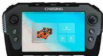
CHASING WSRC cuenta con una pantalla táctil de alto brillo de 7 pulgadas, fácil de operar y receptiva, configurada con teclas de acceso directo para realizar la integración humano-computadora, y disponible para múltiples modos de conexión y dos bandas de frecuencia de comunicación para garantizar una conexión estable y confiable y transmisión.
