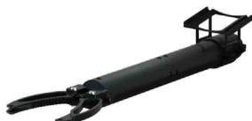
CHASING Grabber Arm 2 con una abrazadera estándar de dos mordazas es un brazo robótico reemplazable desarrollado para drones submarinos CHASING. Admite el reemplazo rápido del muestreador de sedimentos, la garra circular y otros cabezales de herramientas.
